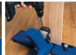
Le gabarit multi-fonctions permet de créer des joints pour trou de poche dans des matériaux de 13 à 38 mm d'épaisseur.
