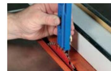
Régler la hauteur des mèches et des lames.
