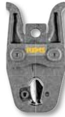
En acier spécial forgé et spécialement trempé. Inserts pour pince à couper les câbles, avec géométrie de coupe usinée de façon extrêmement précise sur CNC-centre d'usinage pour une très longue durabilité. Grand rayon de coupe. Entraînement par toutes les sertisseuses radiales REMS (à l'exception de REMS Mini-Press ACC, REMS Mini-Press 22V ACC, REMS Mini-Press S 22V ACC) et par des sertisseuses radiales appropriées d'autres marques.
