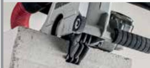
Convient à la réalisation de rainures d'une largeur max. de 30 mm sans traverse en une seule étape
